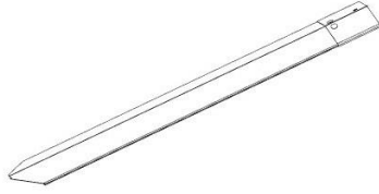
A4M01258 MONTAJE DE EMPALME DE LA TAPA DE LA CUMBRERA (x4)
